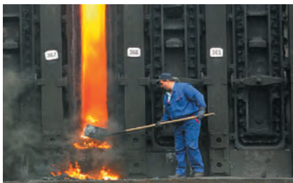
Рис. 29.5. Из коксохимической печи достают готовый кокс
